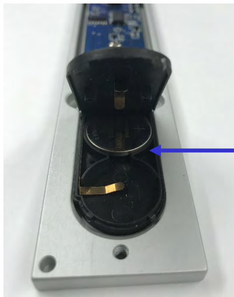
内部2個のうち、必ず上部の1個のみ交換してください。 使用電池CR2032x1個
