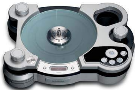
プラッターを浮上させるためのガラスベース面 ガラス面中央部はプラッターの中心を出すためのセンターシャフト プラッター浮上中はセンターシャフトも一緒に浮上し、機械的な接点を作りません
